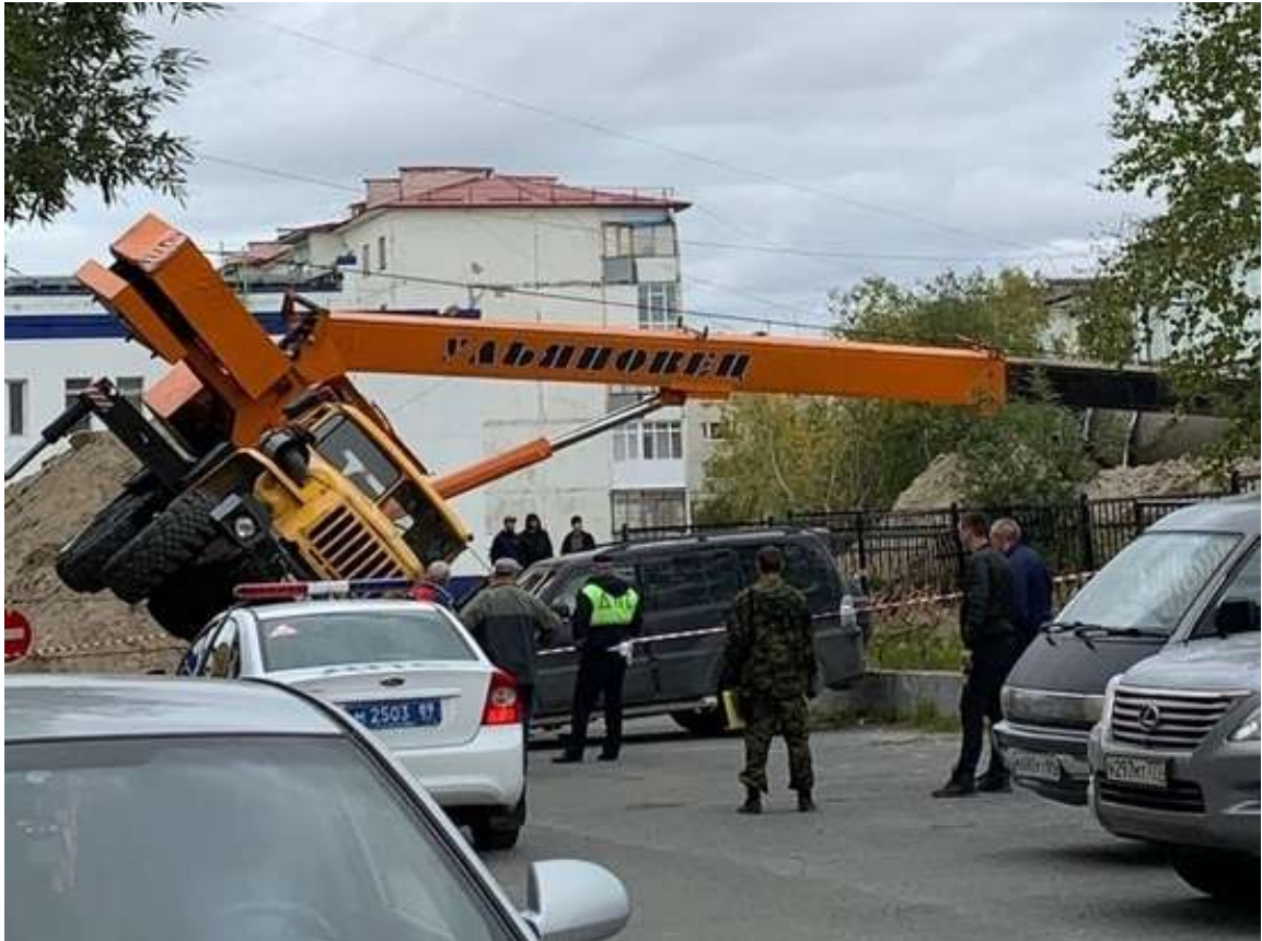
Рисунок 1.4 – Опрокидывание автокрана на припаркованный автомобиль
