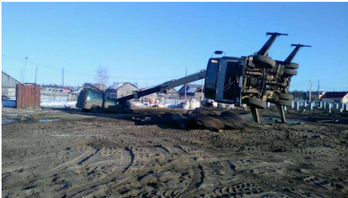
Рисунок 1.5 – Опрокидывание автокрана на автомобиль в результате просадки грунта
