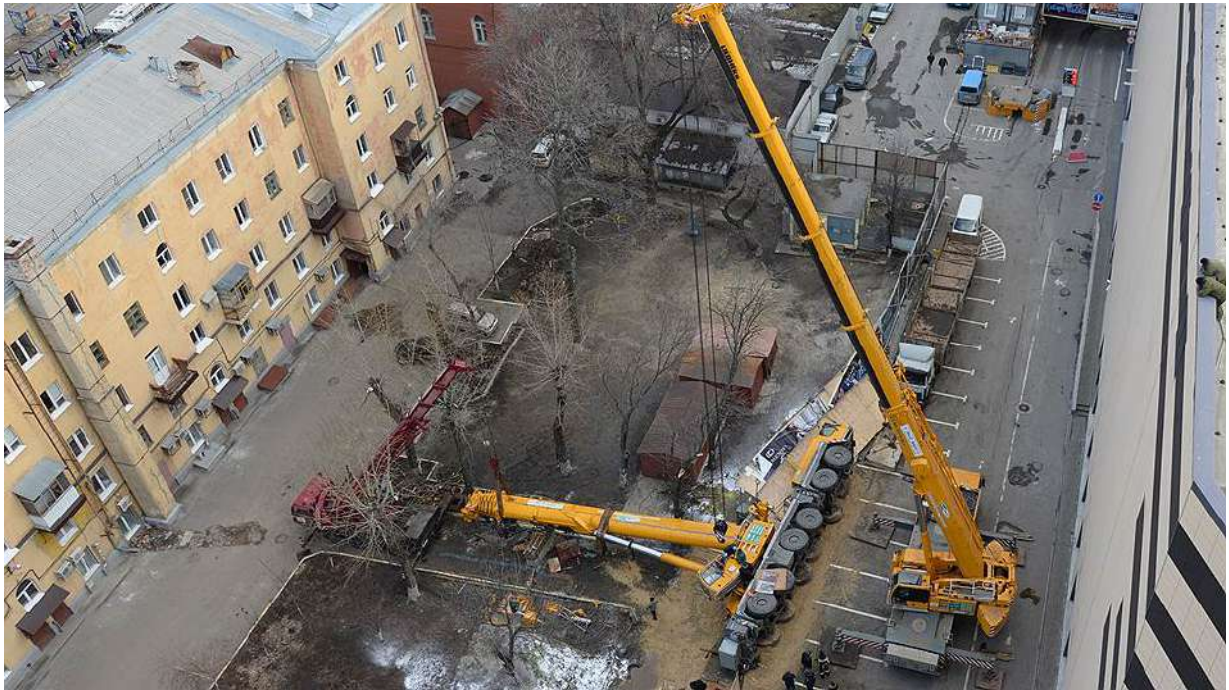
Рисунок 1.3 – Подъем опрокинувшегося в результате сильного порыва ветра автокрана
